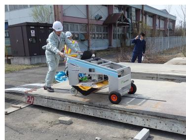
写真-2 電磁波レーダ法による調査状況
