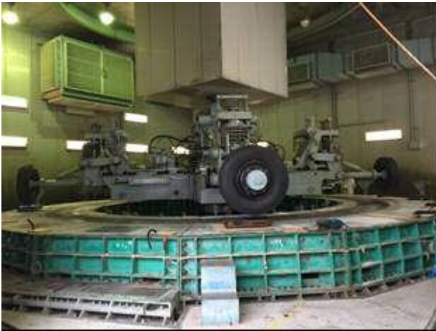
写真-2 回転式舗装試験機
