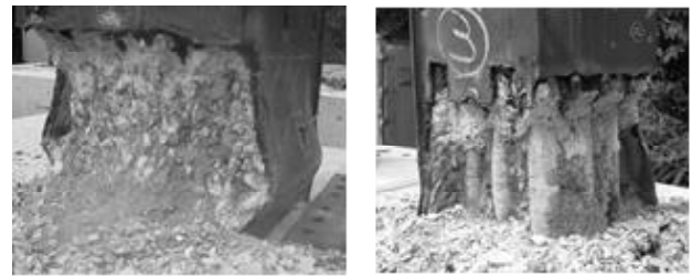
(a)コンクリート充填 (b)コンクリート充填 +スパイラル補強
