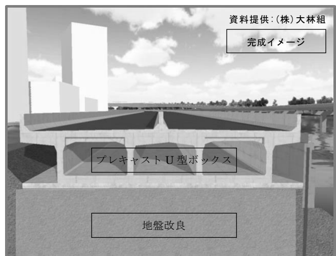
図-13 鮫洲埋立部(更新線)の構造概要
