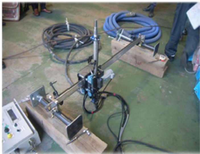
自動遊間ブラスト装置による素地調整
