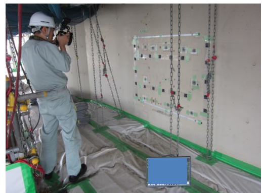
写真 3.2 孔位置写真計測状況
