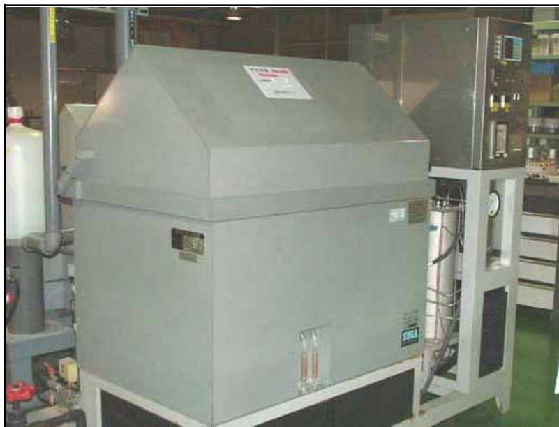
スガ試験機株式会社製複合サイクル試験機
