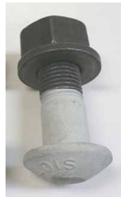
Al-Mg溶射トルシア形高力ボルト (頭部溶射:箱桁接合部などで使用)
