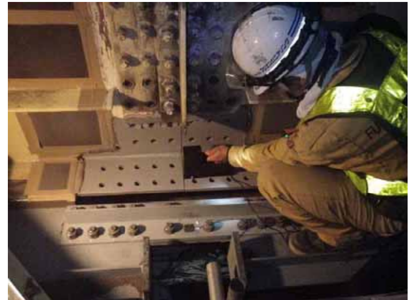
レーザー散乱光粗さ計による ブラスト処理面の仕上り程度確認
