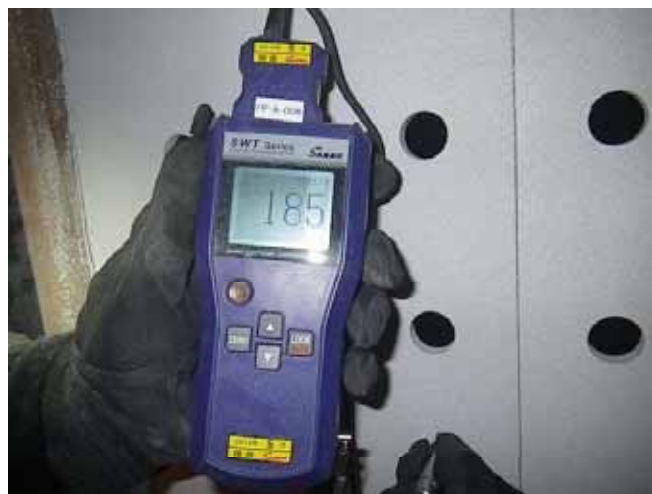
触針式の表面粗さ計測
