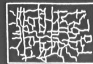
格子状 ひび割れ
