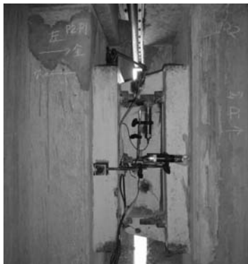
写真-1 ゲルバーヒンジ部の変位計測
