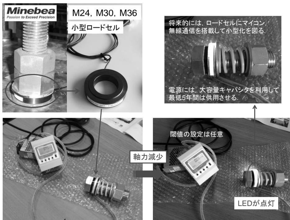
図-9 ボルト締結力監視センサ
