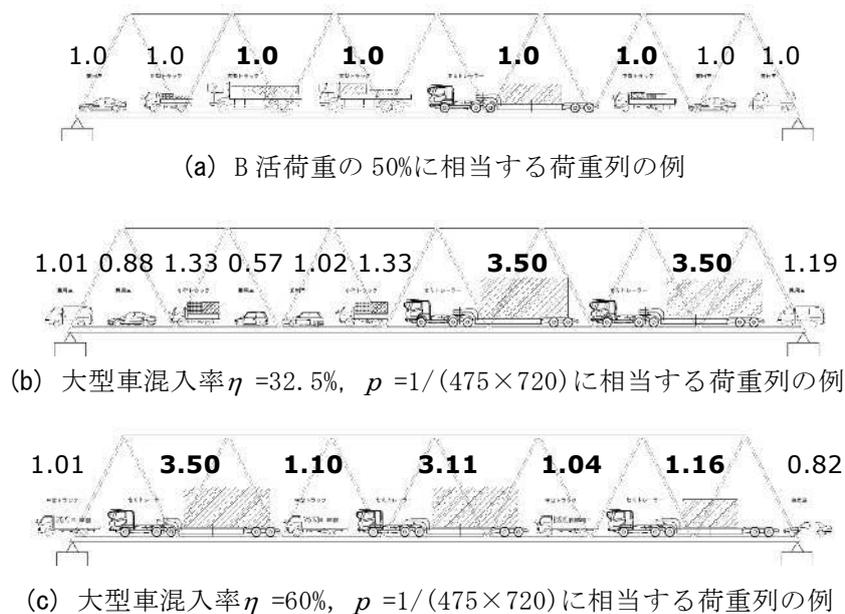
図-3 シミュレーションによる荷重列 (図中数値は平均重量に対する倍率, 太字は大型車)
