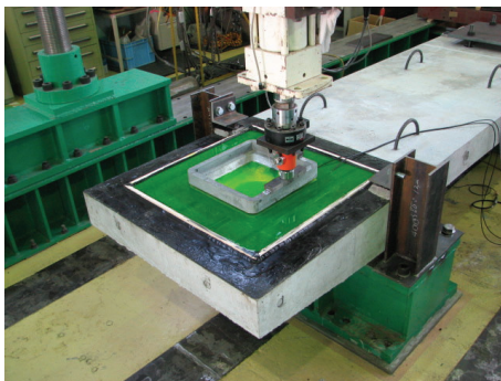
写真-2 載荷点 1 の実験のセットアップ(蛍光色の部分が着色した水)
