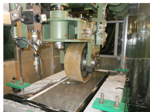
写真-2 試験状況写真 (水張り)
