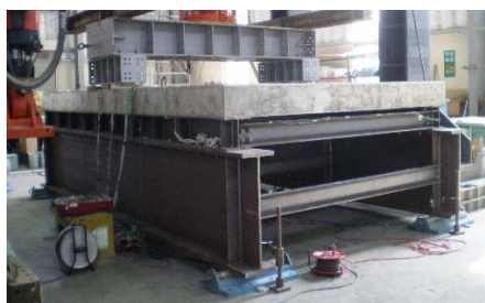
写真-6 主桁作用の載荷状況
