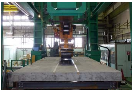
写真-5 輪荷重走行試験状況
