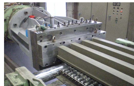
写真-2 RAFの押出し成形状況
