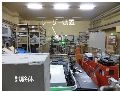
写真-1 レーザーシステムより 8m 離れた試験体(左)と 2 本の検知用レーザー(右)
