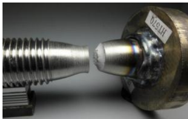
写真-1 引張試験後の上向き溶接したスタッドボルト
