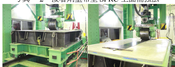
(1) 鋼床版の疲労試験
