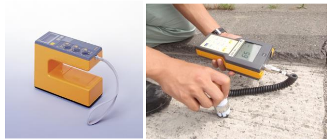
(a) 現行の水分計 (高周波容量式) (b) 新型水分計 (電気抵抗式)
