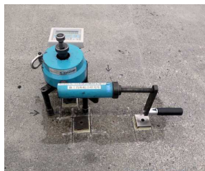
写真-5 サンドパッチング法 写真-6 建研式引張試験
