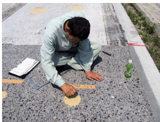
写真-5 サンドパッチング法 写真-6 建研式引張試験
