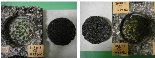
写真-2 舗装厚 20mm 破壊状況 (左 3HAH-3②、右 3HBH-3③)
