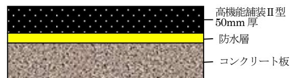
図-2 水浸ホイールトラッキング供試体断面図
