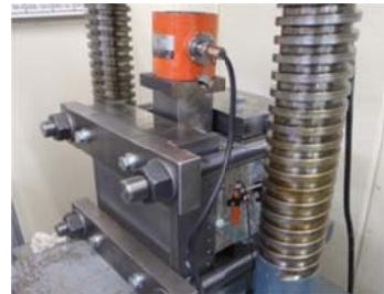
写真-1 せん断接着試験の状況
