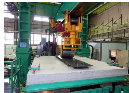
写真-4 輪荷重走行試験機 (クランク式)
