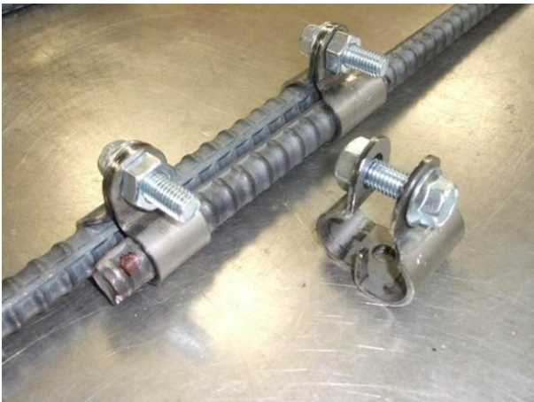
写真-1 締付金具を用いた鉄筋継手
