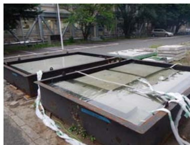
写真-3 5%NaCl 浸漬養生状況
