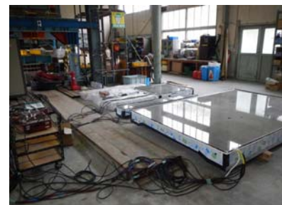
写真-4 真水湛水養生状況
