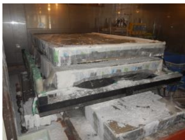
写真-2 ASR 促進養生状況
