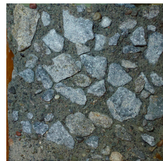
写真-3 洗い出し後の打継面の状態
