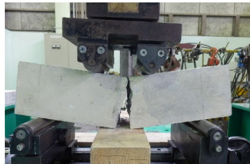
写真-4 曲げ荷重試験の状況（疲労荷重）
