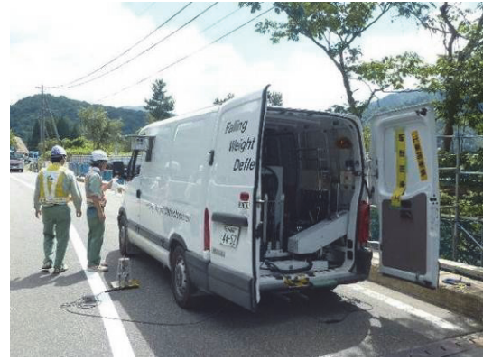
写真-2 車載型 FWD による衝撃荷重載荷試験
