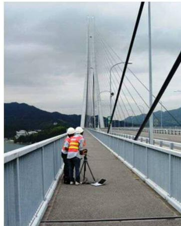
鋼箱桁橋の振動計測 ケーブルの遠隔計測
