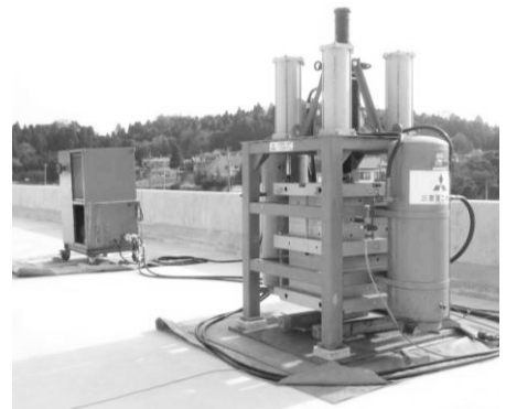
写真-1 起振機設置状況
