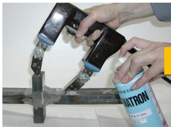
磁化および磁粉検査液の散布
