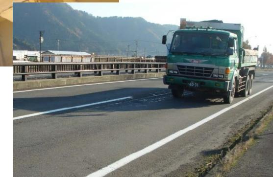
荷重車走行時の部材各部のひずみを計測
