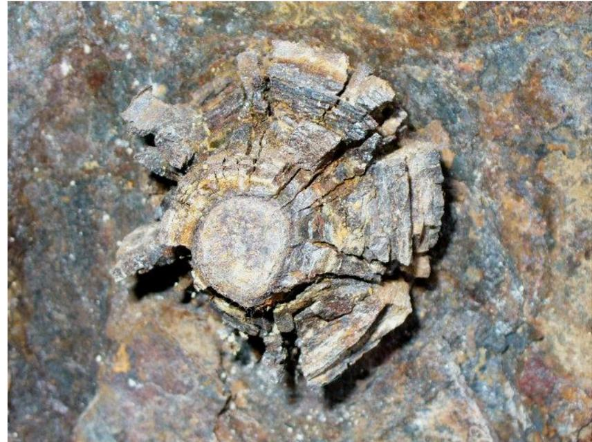
高力ボルトの腐食
