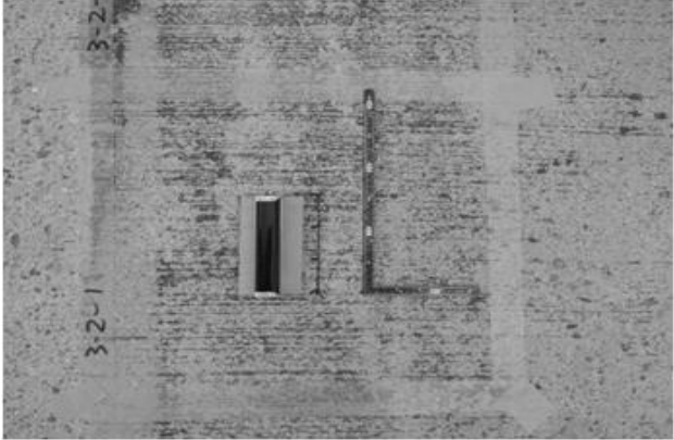
写真-7 残存タックコートの除去状況 (SS照射密度30kg/m 2 , 照射回数1回)
