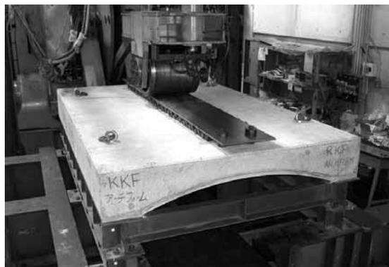
写真 - 2 曲面状埋設型枠を用いたコンクリート系合成床版（輪荷重走行試験による疲労耐久性の確認状況）
