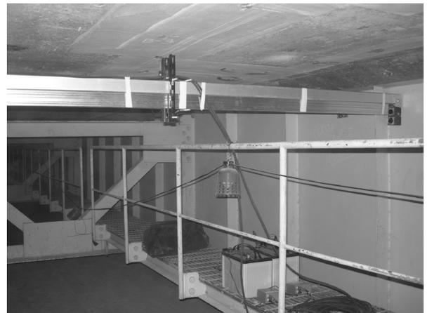
図-6 不動梁を利用した床版たわみ測定
