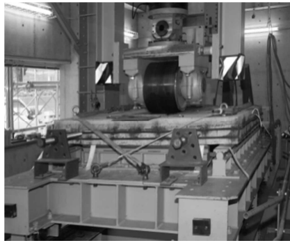
写真-2 輪荷重走行疲労実験装置
