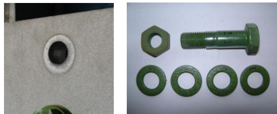
(a) アルミニウム板 (b) ボルトセット（腐食除去後） 写真-12 取り外し後の状況（試験体 I-1, フッ素樹脂）
