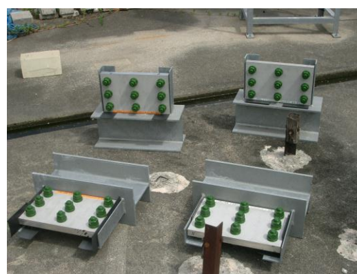
写真-7 暴露試験体設置状況
