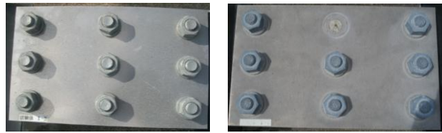
(a) 暴露初期状態（表面） (b) 暴露 49 ヶ月後（表面） 写真-10 暴露後の状況（試験体 I-5, 亜鉛メッキ横置）
