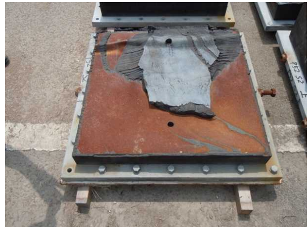
写真17 撤去された損傷したゴム支承
