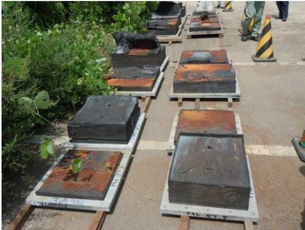
写真17 撤去された損傷したゴム支承
