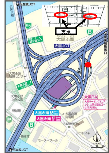
図2.1.23 大黒JCT連結路の損傷箇所
