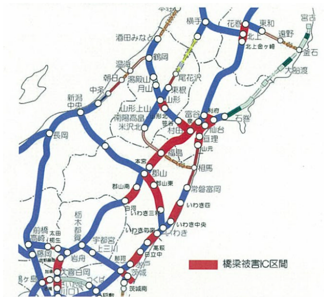
図 2.1.2 高速道路橋の被害分布 (東日本高速道路資料提供)
