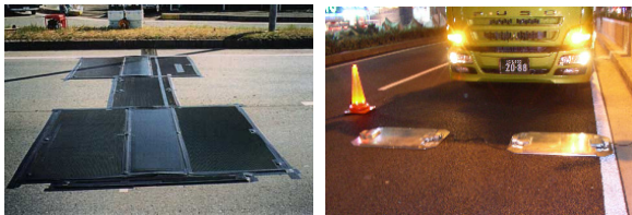
(a) 荷重マット (b) 可搬式軸重計
