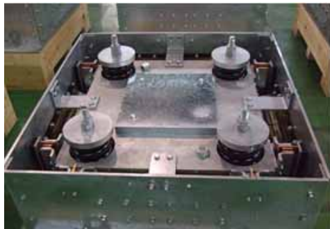
写真-5.3.2 TMD (磁気減衰)
