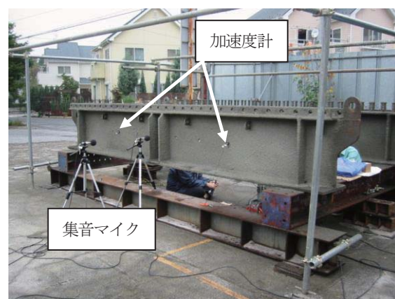
図-3 衝撃加振試験状況 (ゴムラテックスモルタル吹き付け後)
