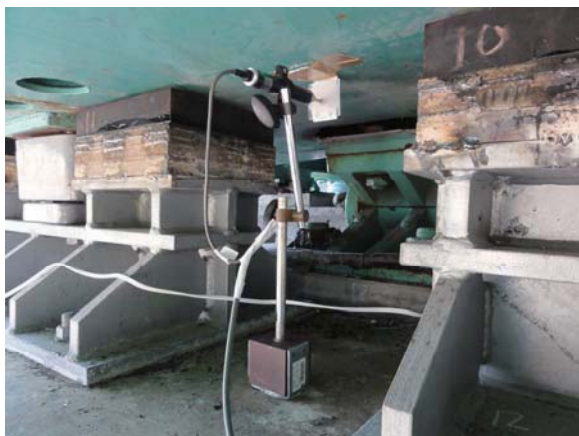
写真-9 変位計(CDP-25, 橋軸方向)
