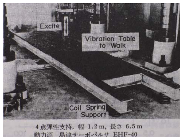
写真-1 金沢大学工学部大型構造物試験装置と振動台
