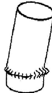
(b) 円形断面鋼製橋脚における変形の集中、進展に伴う傾斜、割れ
