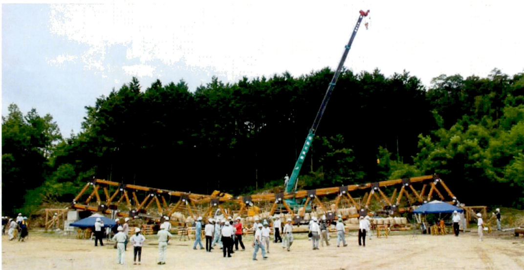
写真1 土嚢積載により破壊した13年の供用履歴を持つ木トラス橋
