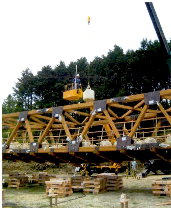
写真3 クレーンにより床板上に土嚢を載せる（写真は一次破壊後）
