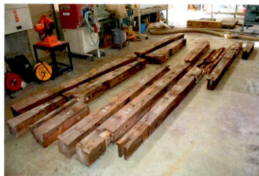
写真-2.4.9 解体後の各部材
