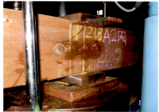
写真-2.4.4 高欄下ばりめり込み試験の様子
