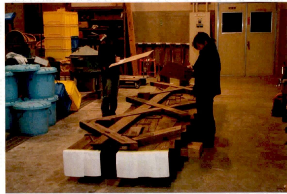
写真-2.4.7 目視による診断の様子
