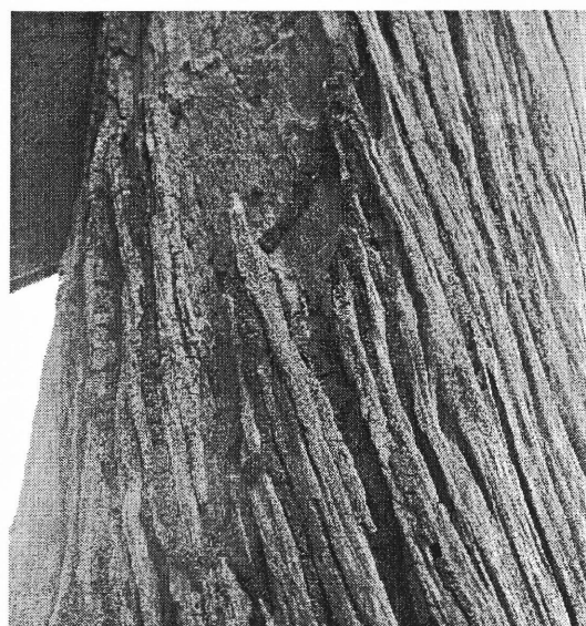
写真-7 おびただしい蟻道 (辺材部のみ)
