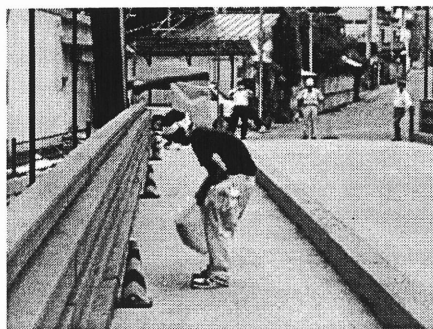
写真-3 砂袋落下衝撃試験
