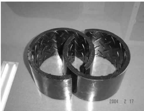
写真-6.5.1 鋼管井筒と継手
