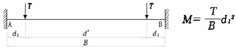
図-6.1.12 継手板曲げモーメント算出
