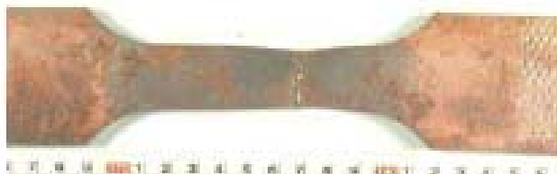
写真-4.1.12 引張試験片外観
