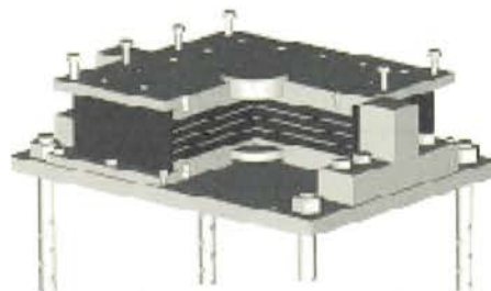
図1.23 地震時水平力分散 ゴム支承の構造図
