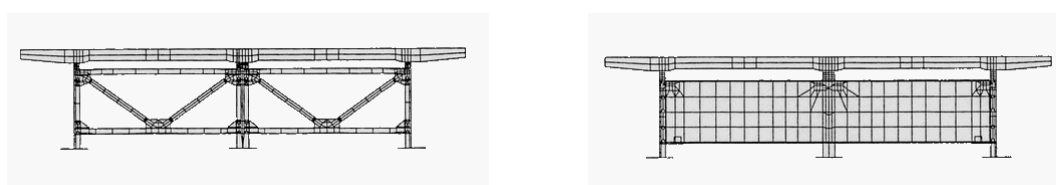
(a)中間対傾構部
